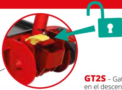
**GT2S** - Gato de 2 toneladas equipado con bloqueo mecánico en el descenso. Exclusivo sistema de seguridad que evita la bajada accidental de la carga bloqueándola a 320mm. Pedal amarillo para el desbloqueo del sistema.
